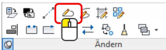
Linien in eine Polylinie verwandeln und mit der Option **[Verbinden]** zu einem Objekt verbinden.
