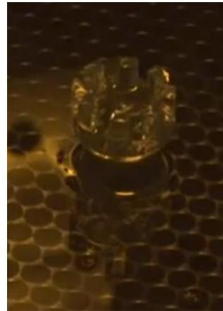
Dann fährt die Plattform 0.1 mm nach unten und der Vorgang wiederholt sich Schicht um Schicht. Nach Hunderten von Schichten taucht das 3D-Objekt aus dem Harzbad auf. Dann lässt man das flüssige Harz abtropfen.
